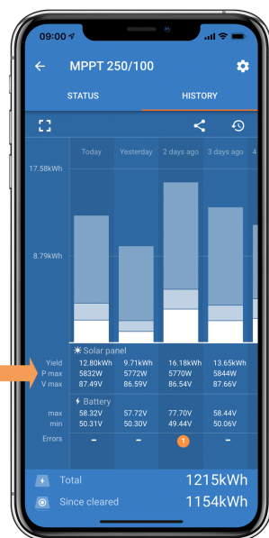
Cronologia di lettura della Pmax dell'app VictronConnect.
