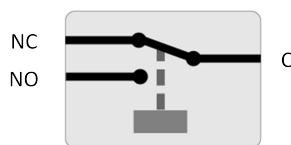
Configurazione del relè (non alimentato).
