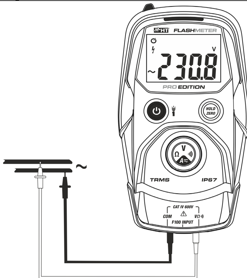
Abb. 4: Verwendung des Gerätes für Wechselspannungsmessung
