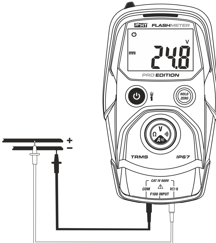
Fig. 3: Uso dello strumento per misura di Tensione DC
