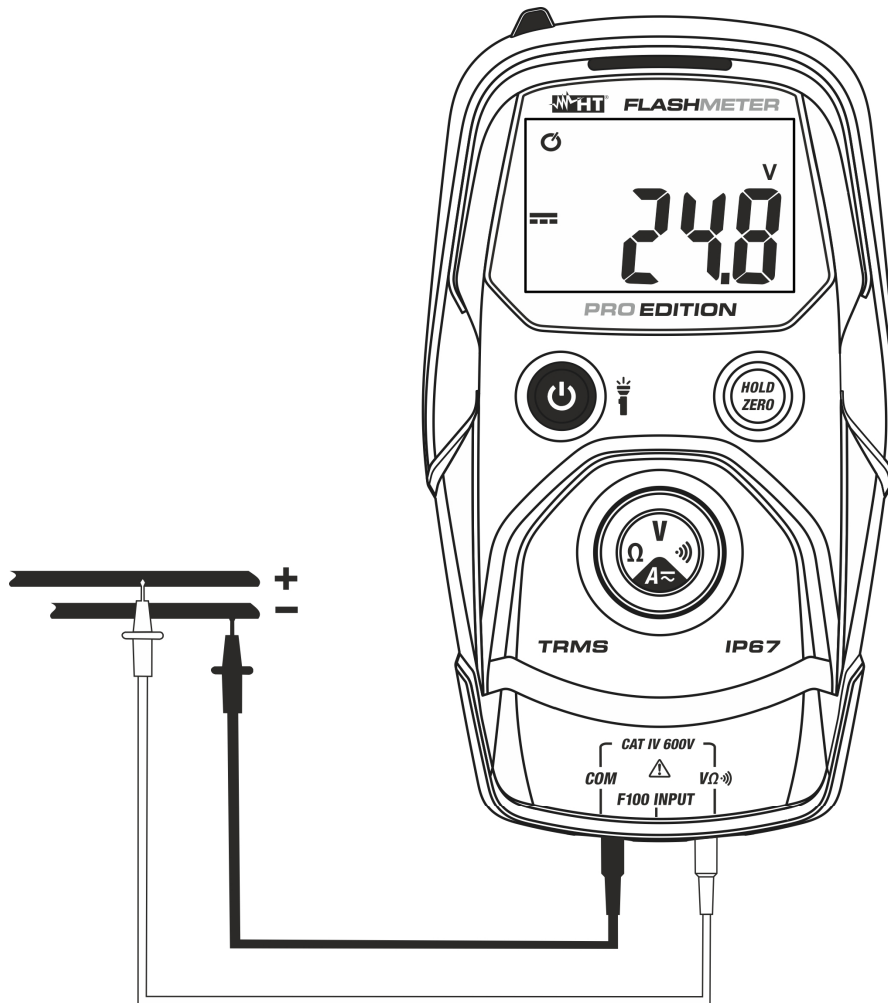
Fig. 3: Utilisation de l'instrument pour la mesure de la Tension CC
