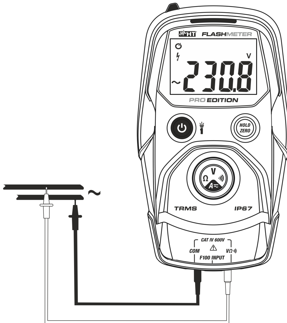
Fig. 4: Uso do instrumento para a medição de Tensões CA
