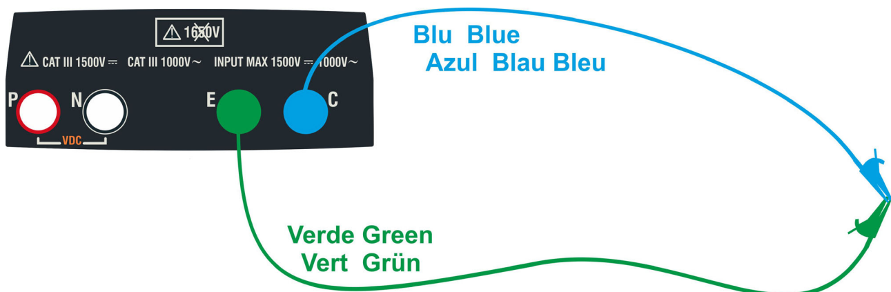
Fig. 4: Compensazione della resistenza dei cavi di misura
