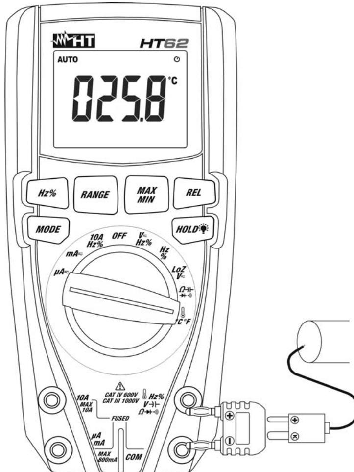
Fig. 9: Uso dello strumento per misura di Temperatura
