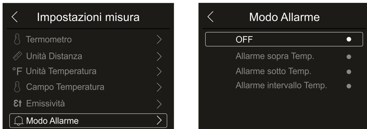
Fig. 29: Menu attivazione soglie di allarme sulla misura
